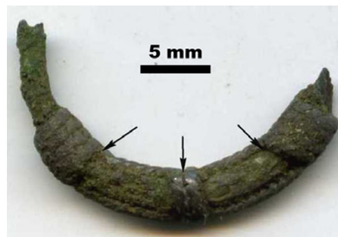
Рис. 21. Внешний вид первого фрагмента височного кольца, стрелками показаны участки со следами припоя
