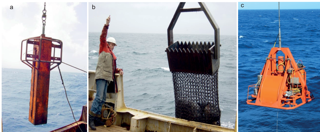
Рис. 2. Аппаратура для подъёма вещества со дна: а — коробчатый пробоотборник; б — скальная драга; в — грейфер с видеокamerой
