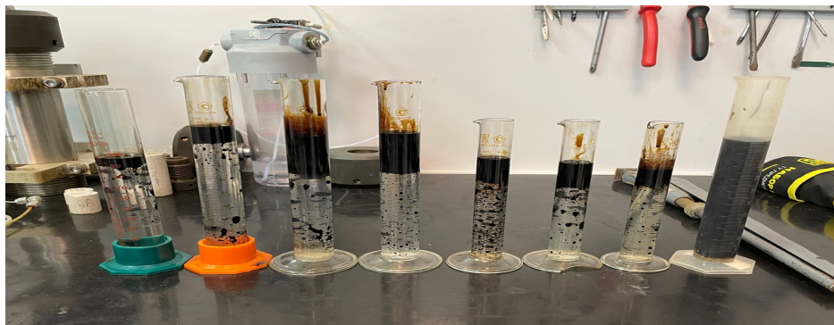
Фото 2. Мерные цилиндры с вытесненной из модели жидкостью до нагрева в сушильном шкафу. Photo 2. Graduated cylinders with the liquid displaced from the model before heating in a drying oven.
