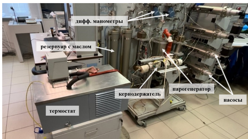
Фото 1. Применявшееся оборудование при нахождении коэффициента вытеснения нефти из физической модели пласта.
