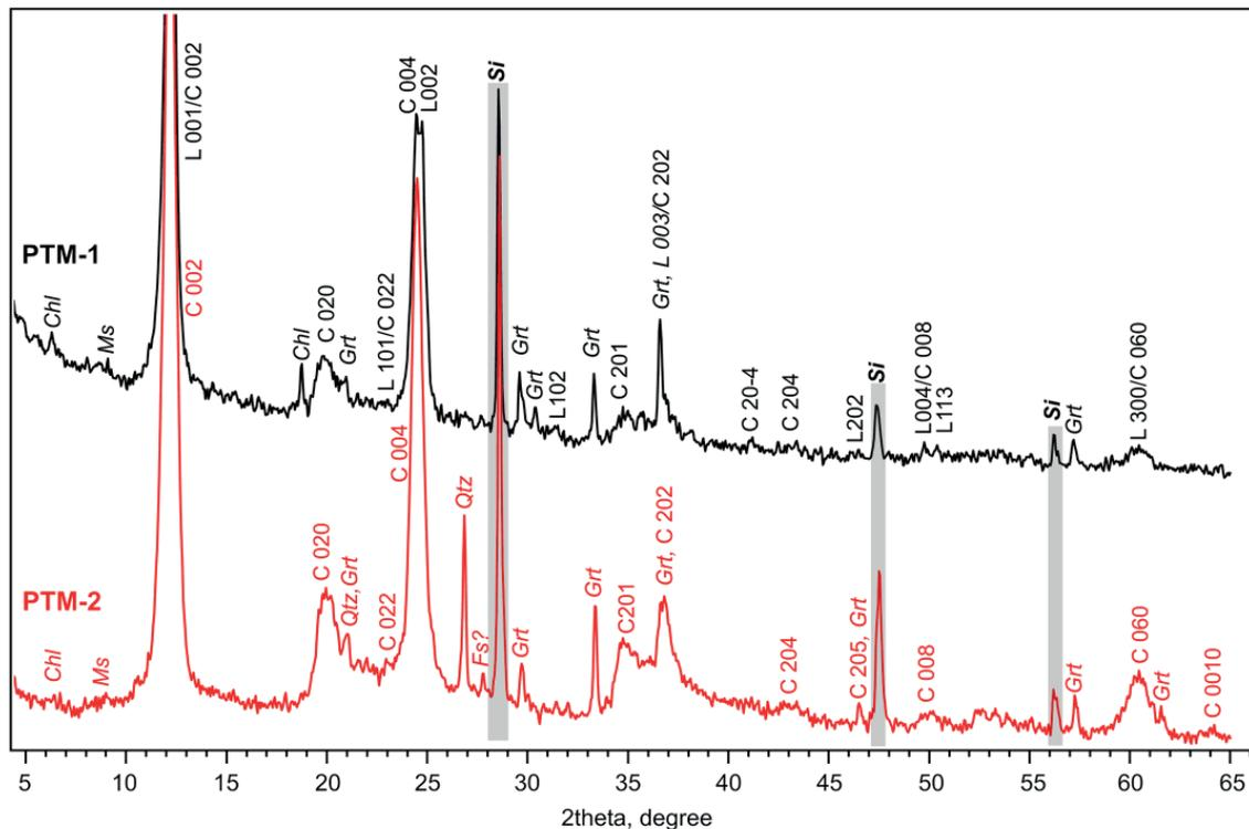
**Рис. 5.** Диффрактограммы образцов вмещающих пород PTM-1 и PTM-2. C hkl и L hkl — рефлексы хризотила и лизардита; Grt, Chl, Ms, Qtz — граната, хлорита, иллита и кварца; Si — эталонного кристаллического кремния
