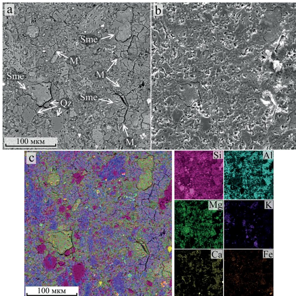
**Рис. 3.** Структурно-текстурные особенности (СЭМ-изображения: а — BSE, b — SE) и карты распределения химических элементов (с) в матрице зювитов донной фации (р. Анарого). М — застывший импактный расплав, Sme — смектит, Qz — кварц
