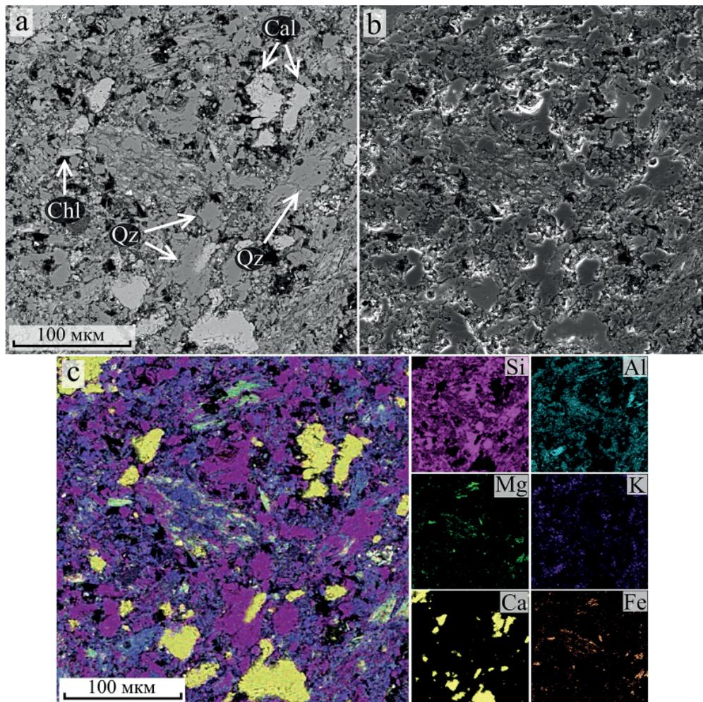
**Рис. 1.** Структурно-текстурные особенности (СЭМ-изображения: а — BSE, б — SE) и карты распределения химических элементов (с) в матриксе зювитов *аэродинамической фации* (р. Кара). Cal — кальцит, Chl — хлорит, Qz — кварц
