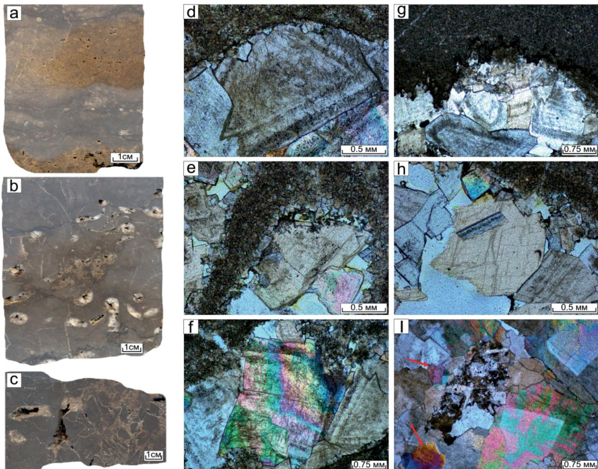
**Рис. 2.** Фото пор, трещин и каверн в образцах и микрофотографии доломитовых и ангидритодоломитовых цементов пород-коллекторов доломитовой пачки скв. 35-Хасырейская (гл. 2300–2376,6 м.): а – обр. 7/1; b – обр. 10/2; c – обр. 5/2; фото шлифов: обр. d–h – обр. 10/2; i – обр. 8/6. Красные стрелки указывают на зерна ангидрита. Пояснения в тексте
