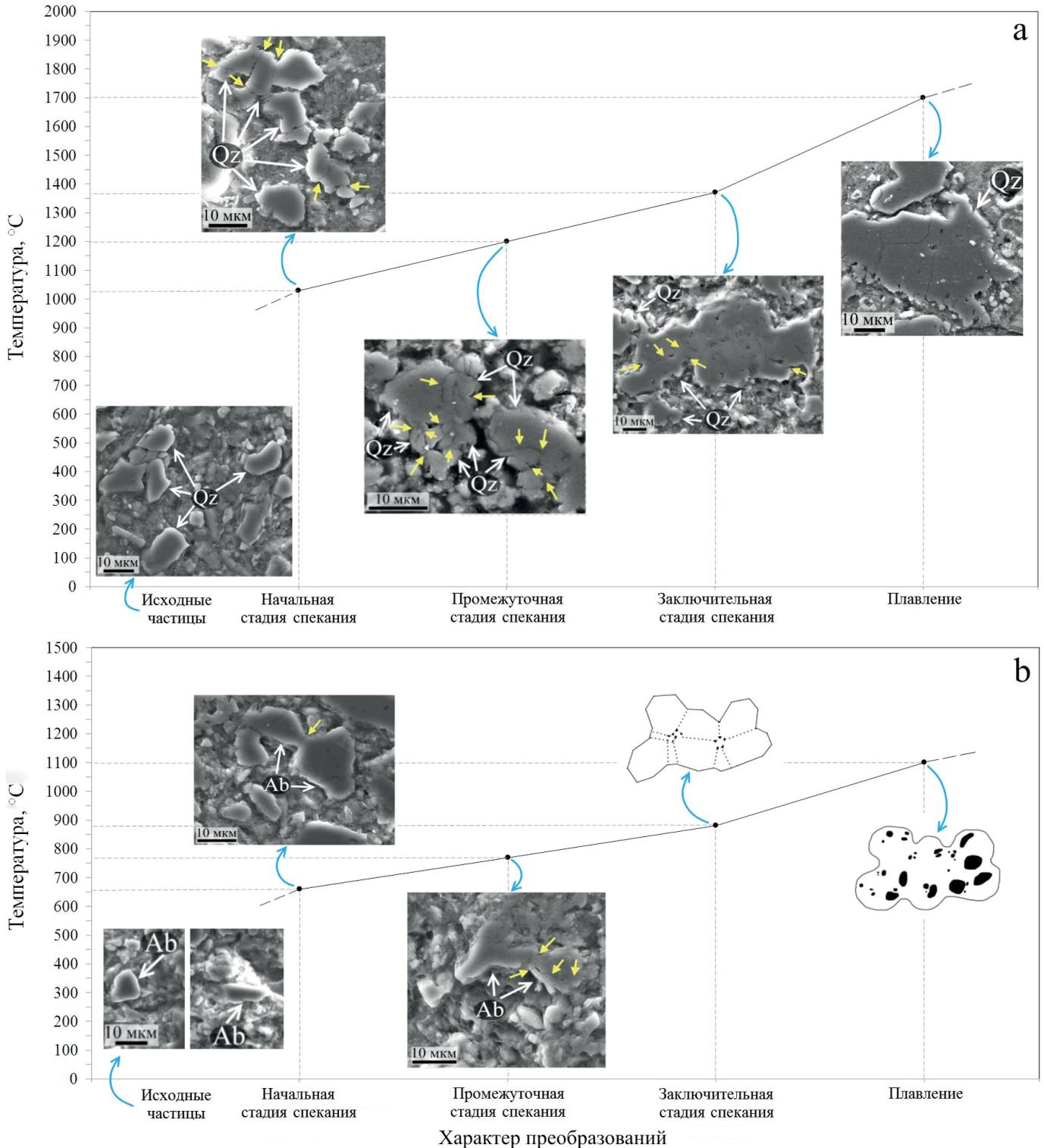
**Рис. 7.** Схема характера преобразования кварца (а) и альбита (б) в матрице зювитов Карской астроблемы в зависимости от температуры. Температуры рассчитаны с использованием данных (Navrotsky et al., 1982; He et al., 2021; Chmielewski et al., 2014; Richerson, Lee, 2018). СЭМ-изображения, SE. Желтыми стрелками показано спекание кристаллокластов
