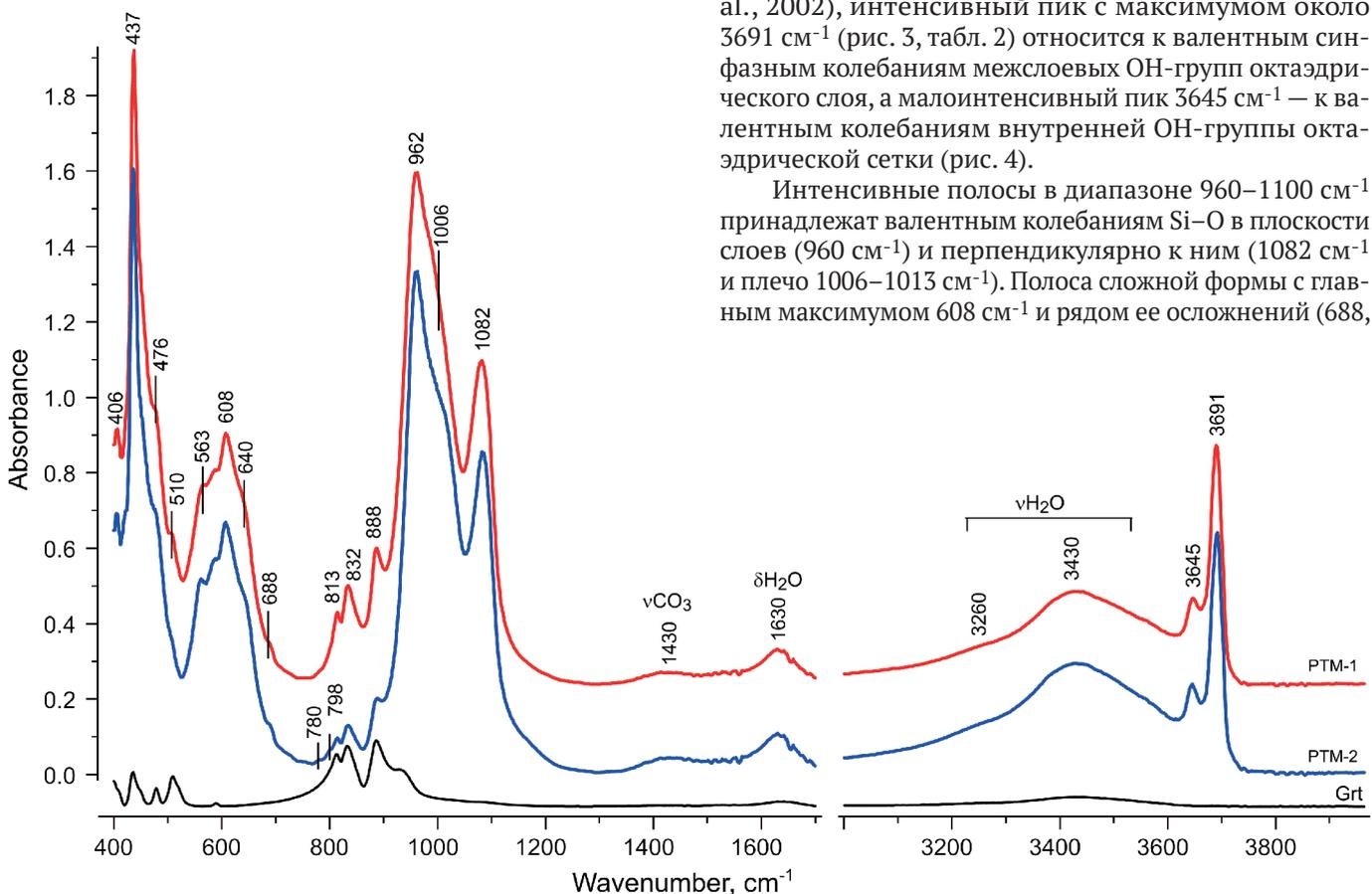
Рис. 3. Спектры ИК-поглощения образцов серпентинитов PTM-1 и PTM-2. Для сравнения в уменьшенном масштабе по оси оптической плотности (absorbance) приведен спектр граната (Grt)
