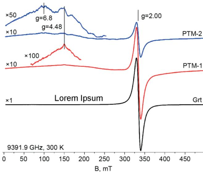
**Рис. 6.** Спектры ЭПР проб РТМ-1 и РТМ-2 в сравнении со спектром ЭПР граната. Условия записи спектров идентичны, навеска — 7 мг. Слева приведены относительные коэффициенты усиления. Низкополевая часть спектров РТМ-1 и РТМ-2 показана с дополнительным усилением ×10 и ×5 соответственно
