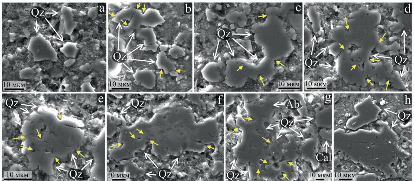
**Рис. 4.** Кристаллокласты кварца (Qz) и альбита (Ab) в матрице зювитов донной фации (СЭМ-изображения, SE). а, с–g — зювиты района р. Кары; б, h — зювиты района р. Анароги. Желтыми стрелками показаны участки спекания кристаллокластов
