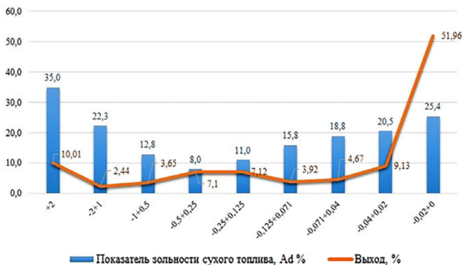
Рис. 1. Гранулометрический анализ исходного сырья с показателями зольности сухого топлива в классах крупности Fig. 1. Granulometric analysis of the raw material with indicators of ash content by size classes
