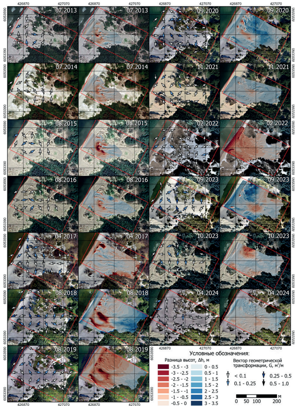
Рис. 4. Межгодовая морфодинамика котловины выдувания за период 2012–2024 гг.: цифровые модели разницы высот \Delta h и перемещения песчаного тела (поток объема) G . Стрелки и их цвет указывают на преобладающее направление потока объема G_{dir} и его магнитуду |G|
