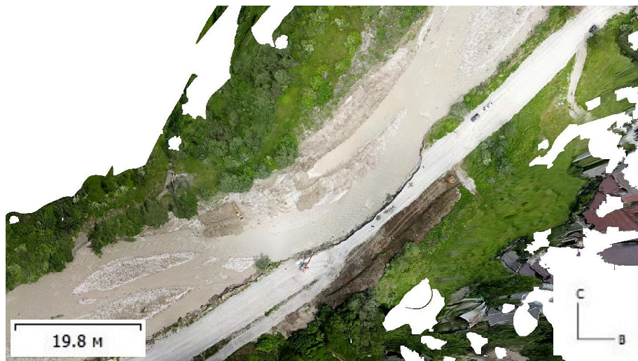
Рис. 2. Участок автодороги, прилегающий к руслу р. Нальчик, разрушенный наносоводным селем
