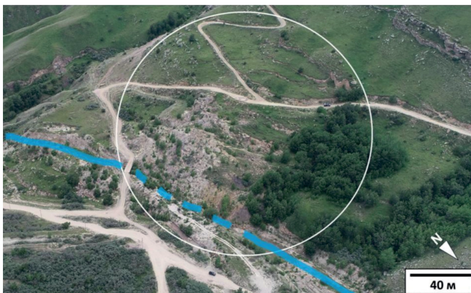
Рис. 3. Оползневой участок в русле открытого аварийного водосброса. Синей линией обозначен водоотводный канал, пунктиром — фрагмент русла, заваленный оползем. Фото с квадрокоптера ГУ МЧС России по КБР. 19.06.2025
