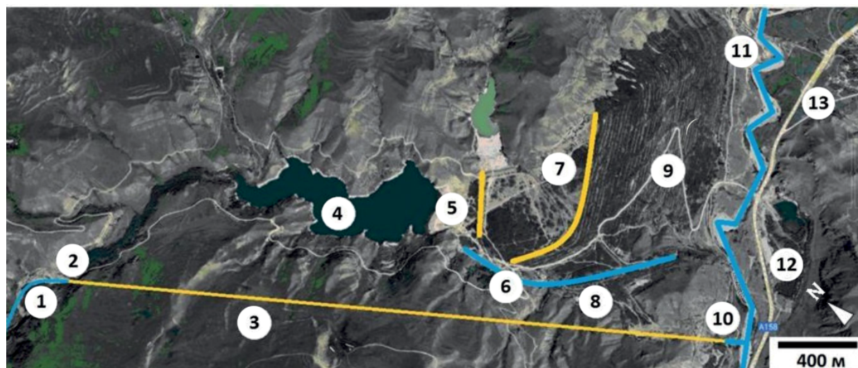
Рис. 1. Схема хвостохранилища Тырнаузского горно-обогатительного комбината на основе космоснимка сервиса GoogleEarth: 1 — селевые отложения 2002, 2014 гг. в русле р. Гижгит на подходе к входному portalу водоотводного тоннеля № 2; 2 — входной портал водоотводного тоннеля № 2; 3 — водоотводный тоннель № 2; 4 — основной водоем-отстойник, емкость — 1–1,2 млн м 3 ; 5 — отсечная плотина при выходе на пляж хвостохранилища; 6 — оползневой участок по правому борту водоотводного канала; 7 — гребень основной плотины; 8 — аварийный открытый водоотводный канал; 9 — расположение очагов высачивания фильтрационных вод в теле основной плотины; 10 — выходной портал водоотводного тоннеля № 2; 11 — русло р. Баксан; 12 — федеральная автодорога; 13 — с. п. Былым
