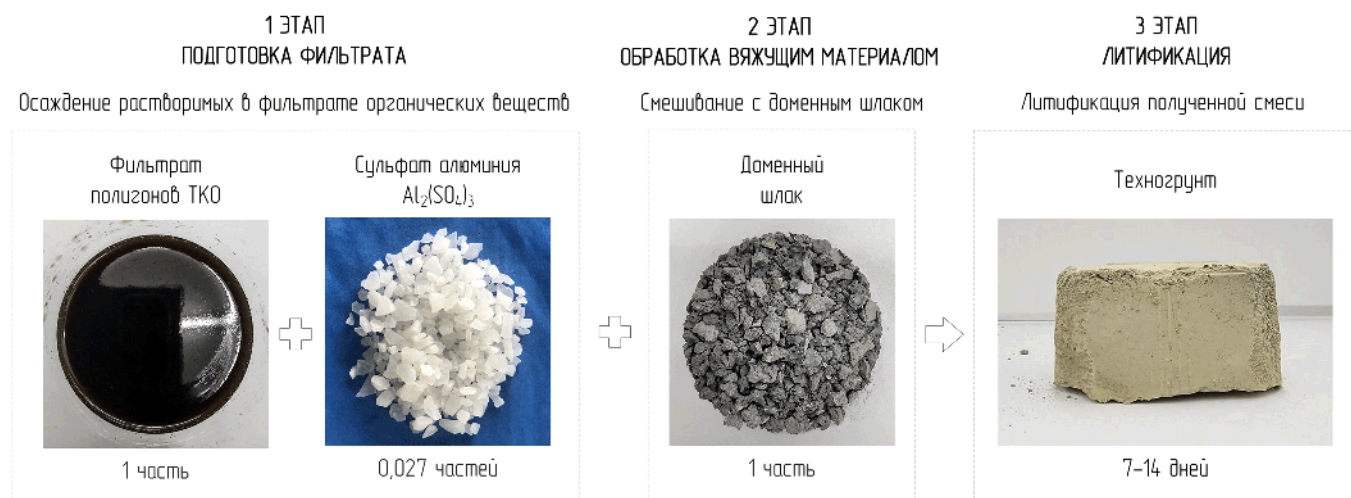
Рис. 1. Схема получения техногрунта на основе свалочного фильтрата
