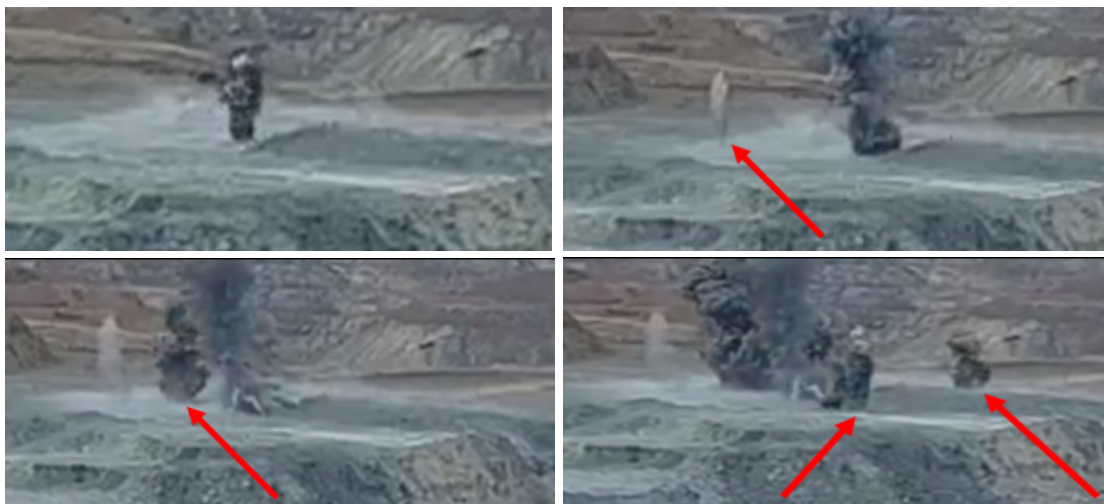
Фото 2. Динамика взрыва блока № 38, гор. 520 на Маломырском руднике, май 2024 года.
