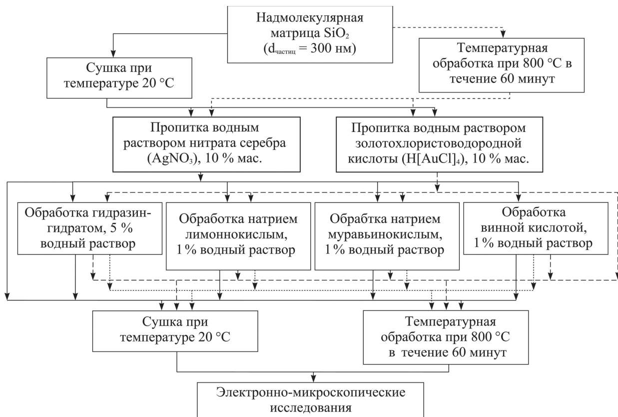
Рис. 2. Схема проведения эксперимента по получению наноконкомпозитных материалов на основе надмолекулярных матриц кремнезема и соединений Au и Ag
